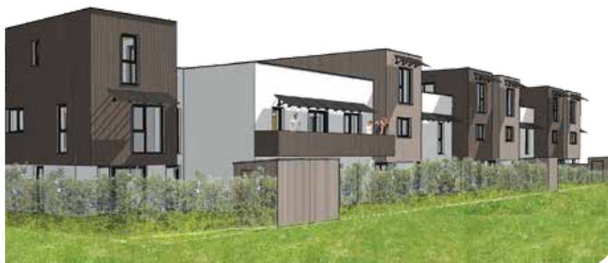
16 logements intermédiaires locatifs à OYE-PLAGE : un bâtiment Label Bio-sourcé de niveau 3 grâce à ses matériaux d'origine végétale ou animale (lames de bois, tissus recyclés, pierre ponce alvéolaire...)
